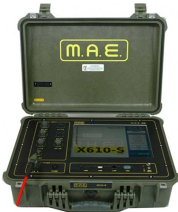
Фиг. 5. 48 канален 24-битов сеизмограф МАЕ Х610-S.
